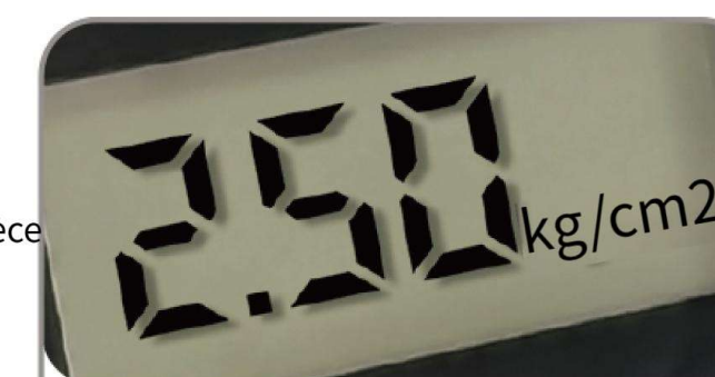
5Appuyez sur l'interrupteur d'alimentation de la pompe à essence, remplissez la valeur définie et remplissez automatiquement l'arrêt.
