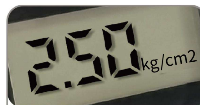
5 premere l'interruttore di alimentazione della pompa del gas, riempire il valore impostato e riempire automaticamente senza fermarsi
