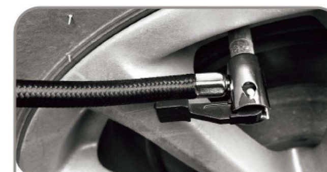
3 nafukovací port je připojen k trysce pro vzduch pneumatiky
