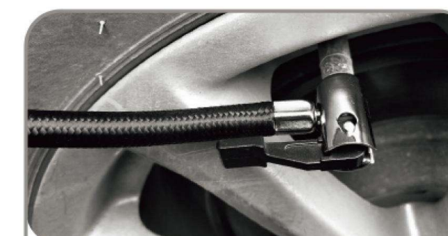
3le port gonflable est connecté à la buse d'air du pneu
