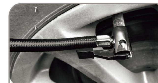
3 el puerto inflable está conectado a la boquilla de aire del neumático
