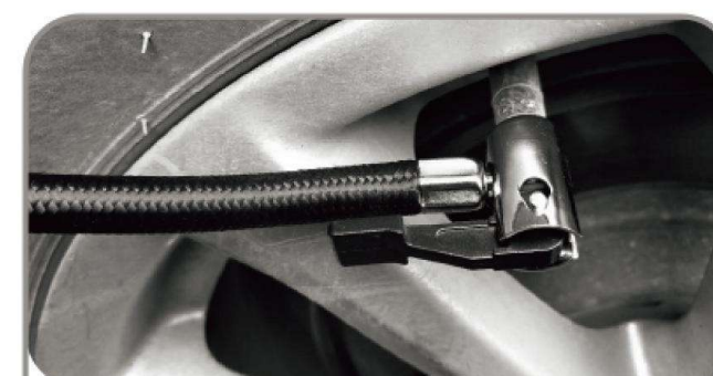
3Der aufblasbare Anschluss ist mit der Reifenluftdüse verbunden
