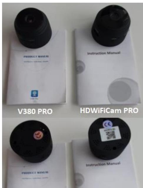
Esistono due modelli di videocamera Sensori. Le videocamere si differenziano solo per l'applicazione che utilizzano. Può capire quale modello di videocamera possiede in base alle istruzioni in italiano allegate e dalla presenza o meno di un codice QR sul fondo della videocamera.
